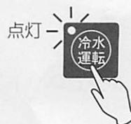
⇒ 冷水運転ランプが点灯し、5 分後に冷水機が運転を開始します。
