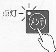
⇒ メンテナンスボタンのランプが点灯し、フロントパネルを開いた状態でのパウダー原料放出が行える状態になります。
