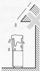
**熱器具禁止** 熱器具（ガスコンロなど）をのせたり、熱器具を周囲に置いたりしないこと
