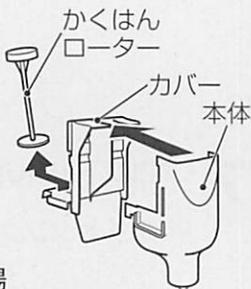
**5** 本体、カバーを中性洗剤に浸け込み洗浄し水洗いします。（コーンスープ対応部品（オプション）がある場合は、一緒に洗浄・水洗いします。）
