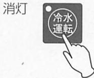
⇒冷水運転ランプが消灯し、冷凍機の運転を停止します。冷水運転ボタンを消灯させても、水（常温水）の注出は可能です。
