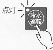
⇒冷水運転ランプが点灯し、5分後に運転を開始します。冷水運転ランプは運転中、点灯し続けます。
